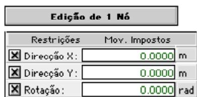
Desmarcar as 3 restrições - o nó deixa de ter encastramento para ser livre.
