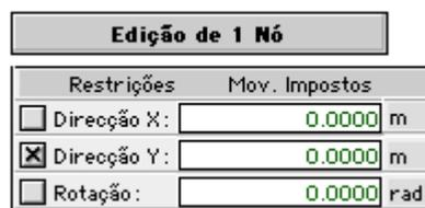
Note-se que a simbologia dos nós alterados passou a ser diferente, permitindo distinguir os encastramentos dos apoios duplos e simples. Podem-se criar apoio e
